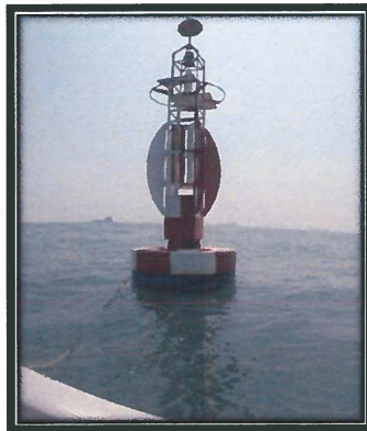
Mantenimiento a boya de recalada que indica el área de fondeo, ubicada en el cadenamamiento -5+100, los trabajos consistieron en la limpieza y revisión de cadena de anclaje, cambio de grillete de 1 1/4" de unión entre cadena y muerto de anclaje.
