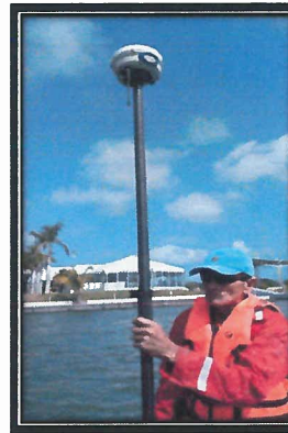
Localización de la coordenada utilizando GPS de precisión para ubicar los muertos y la boya auxiliar de enfilación del primer cambio de rumbo.
