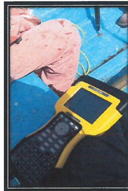
Localización de la coordenada utilizando GPS de precisión para ubicar los muertos y la boya auxiliar de enfilación del primer cambio de rumbo.
