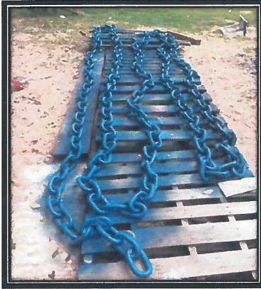
Limpeza y aplicación de pintura de cadena para anclaje de Boyas.
