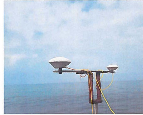
Sensor de movimiento smc imu 108, instalado en el eje del transductor y antenas de gps móvil para indicar el rumbo de la embarcación durante los recorridos
