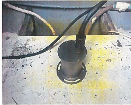
Sensor de movimiento smc imu 108, instalado en el eje del transductor y antenas de gps móvil para indicar el rumbo de la embarcación durante los recorridos
