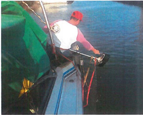
Instalación de transductor odom mkIII doble frecuencia 200/24 khz.
