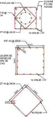
DETALLES DE ACERO DE REFUERZO DE CIMENTACIÓN
