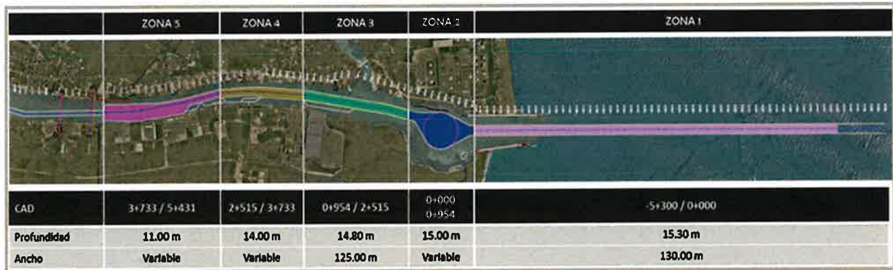
Imagen 1. Vista en planta del Canal de Navegación donde se realizarán los trabajos.
